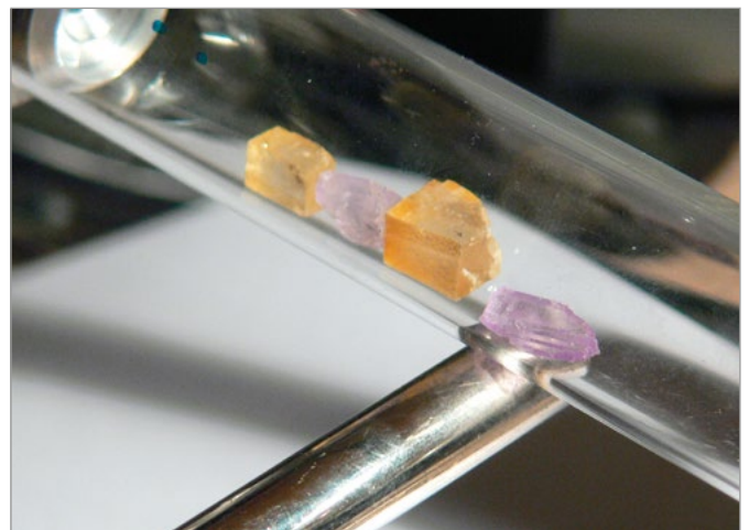
Figura 36. Creació de centres F de color en cristalls inicialment incolor d'halita i silvina, en el buit i sotmesos a la descàrrega d'una bobina de Tesla. Foto i mostres: Adolf Cortel.
