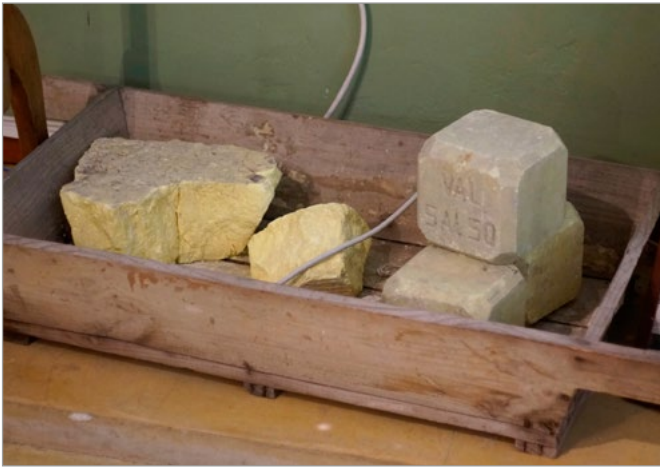
Bandeja de madera donde se enfriaba el azufre líquido conseguido por el método siciliano: azufre en bloque y cubos de azufre del valle del Salso. Foto: Josep A. Ignacio.
